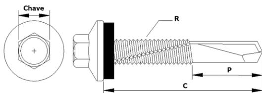
Os fixadores da linha BULLTRAXX® são confeccionados em Aço Carbono 1022 e revestimento de polímero de alumínio, tratamento este que proporciona ao material uma vida útil prolongada e resistência à corrosão como em áreas litorâneas. A qualidade deste tratamento é comprovada através de testes como Ensaio de Saltspray (+1.500 horas de resistência à névoa salina) e Ensaio de Kesternich (30 ciclos de resistência).
